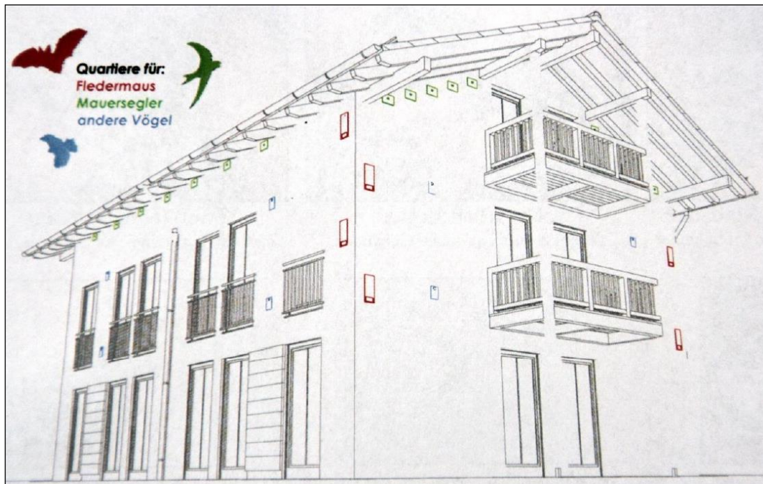
Abb. 5 mögliche Positionen für künstliche Quartiere für Fledermäuse an Gebäuden (Quelle: LBV München)
